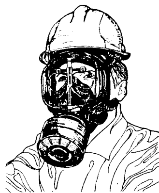
Рис. 9.2. Промышленный противогаз малого габарита ПФМ-1
