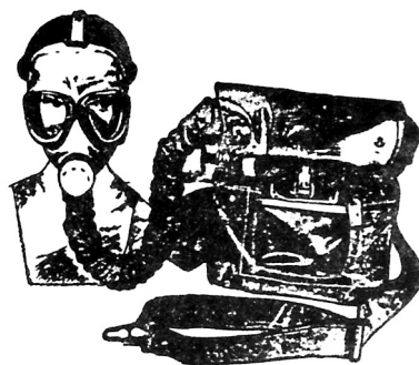
Рис. 9.6. Изолирующий противогаз ИП-4М
